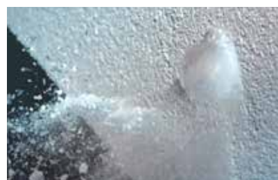
Aufnahme Hochgeschwindigkeitskamera – das WDV-System hält dem Hagelschauer stand.
