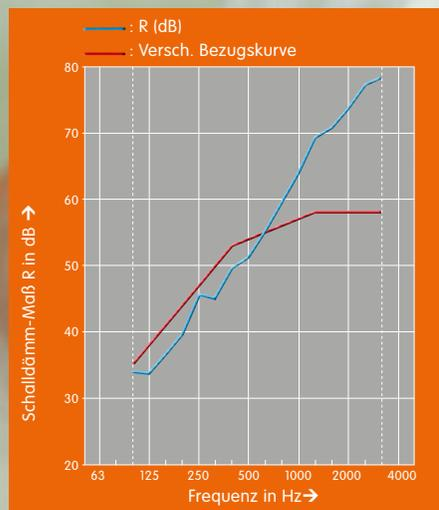
Eine Steigerung des Schalldämmmaßes um 13dB bedeutet eine Verringerung der Schallintensität um 95%.
