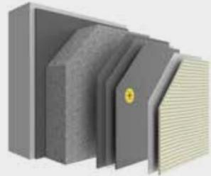
Wärmedämmplatte aus expandiertem Polystyrol-Hartschaum
